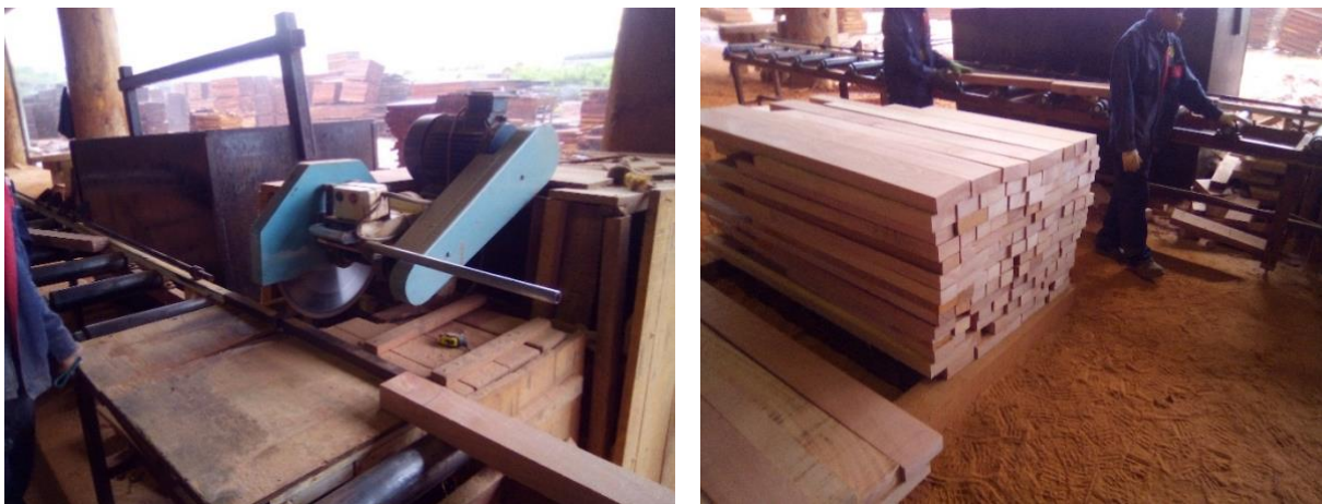
Figure 20 : Vue de la scie ébouteuse et du bois ébouté prêt pour le colisage
