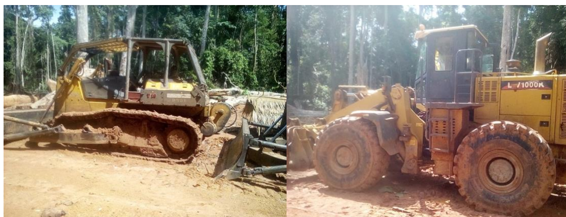
Figure 8: Engin de débardage et de chargement des grumes
