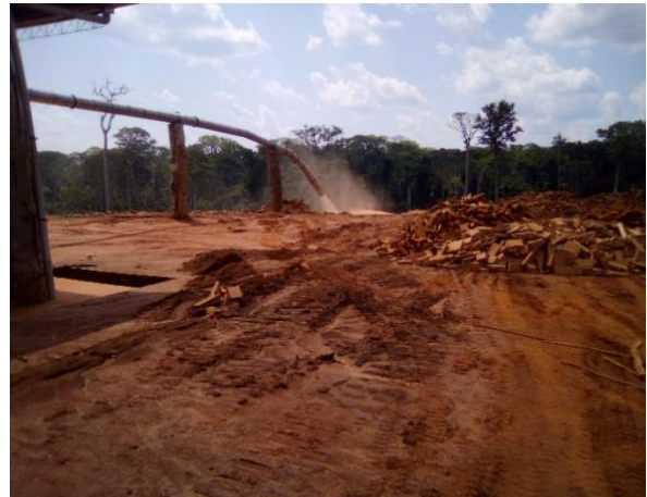
Figure 21 : Vue de l'aspirateur et du refoulement de la sciure après coupe
