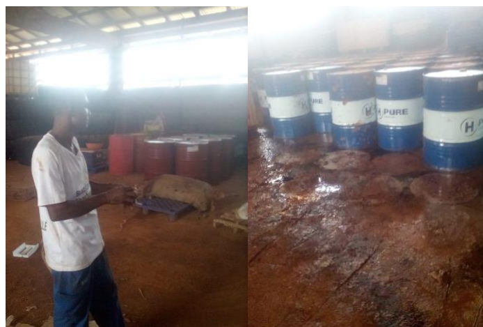
Figure 10 : Ouvrier mal équipé et de l'huile se répand au sol
